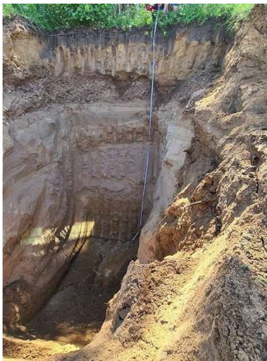
Foto 5.2. Kaevandis SPK-7 kruusaka ja puhta liiva vaheldumine (Foto: Sven Siir, 26.06.2024; N 59°02'45" ja E 24°50'46").
